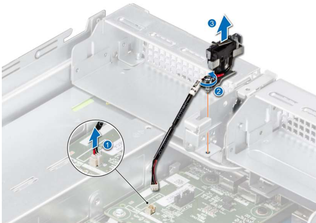
Ilustración 134. Extracción del módulo del interruptor de intrusiones
