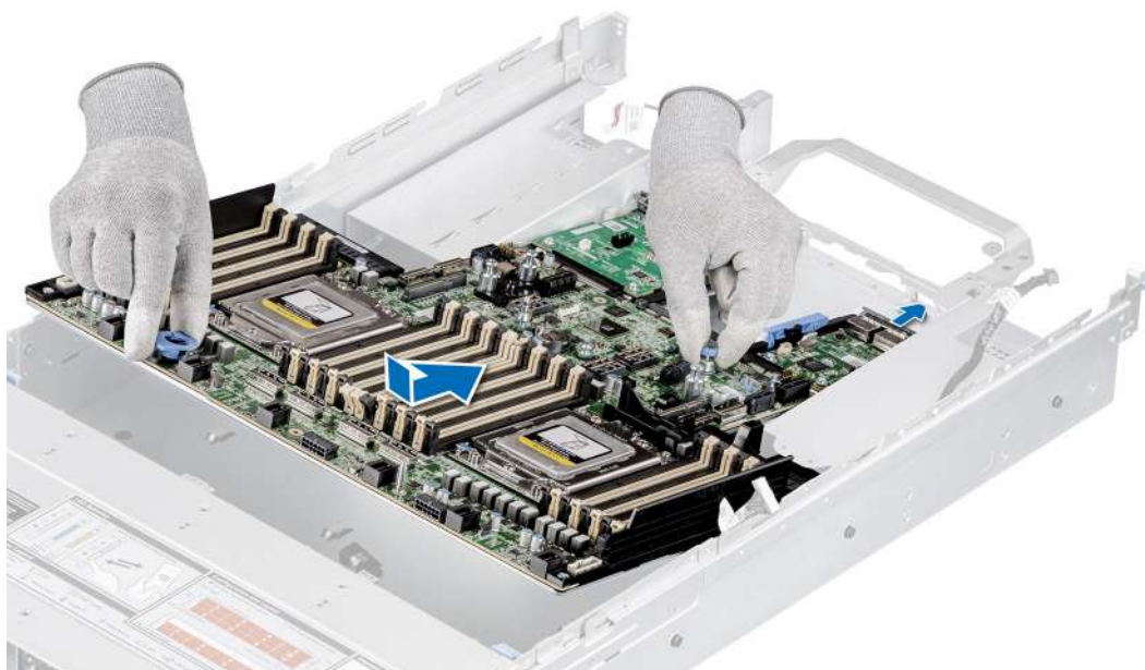
Ilustración 144. Instalación de la tarjeta madre
