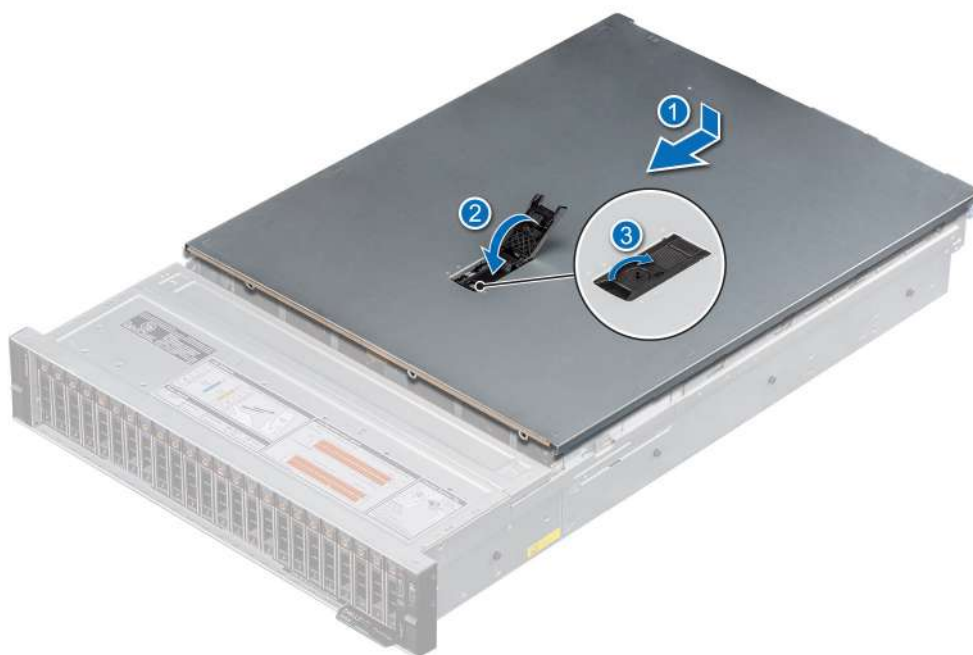
Ilustración 34. Instalación de la cubierta del sistema
