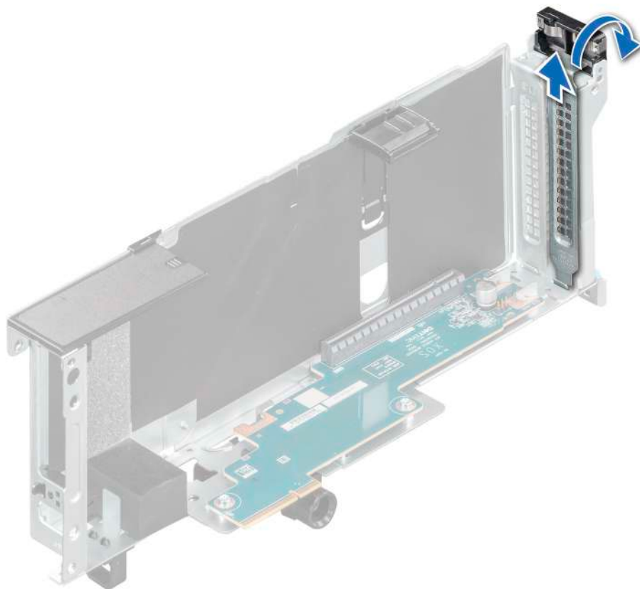
Ilustración 104. Extracción del soporte de relleno metálico
