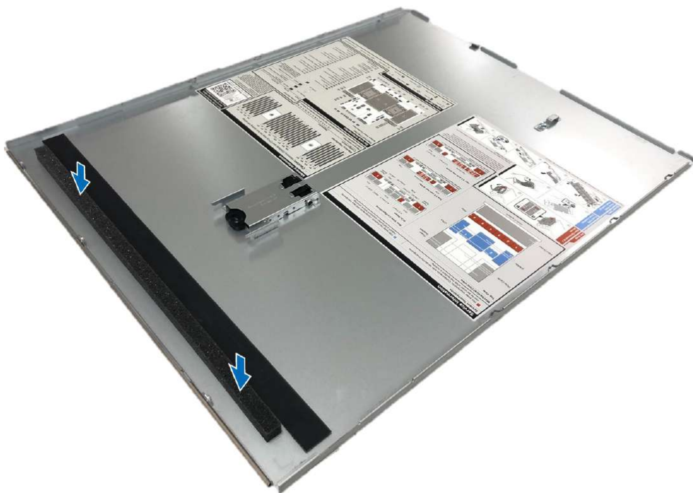
Ilustración 149. Instalación de espuma de mylar en la cubierta del sistema
