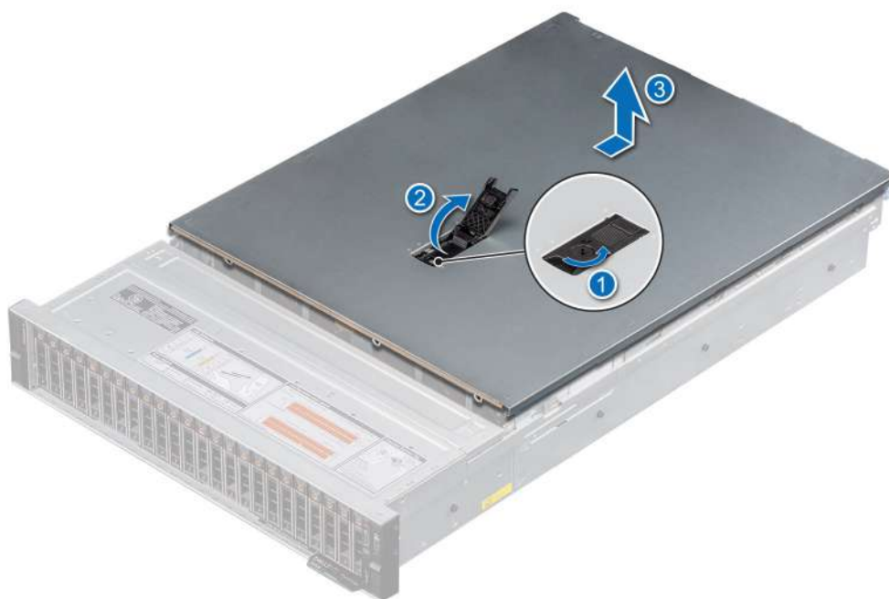
Ilustración 33. Extracción de la cubierta del sistema
